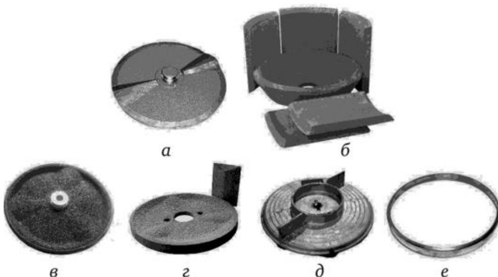
12. Картофелеочистительные машины какого типа имеют рабочий орган в виде вращающегося шероховатого усеченного конуса, установленного на металлическое основание?
