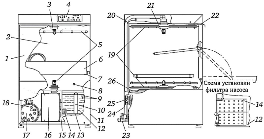
10. Какое устройство фронтальной посудомоечной машины (см. рис. выше) предназначено для перелива излишков моющего раствора в канализацию при работе машины и его слива на дне ванны по окончании работы?
