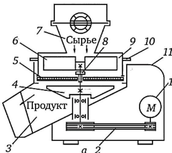
16. Какой механизм протирачно-резательной машины МПР-350 (рис. выше) установлен на приводном валу, его лопатки прижимают продукт к сити 5 и продавливают нарезанный продукт через отверстия?
