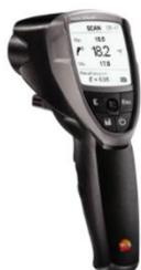
22. Прибор, который бесконтактно производит измерение температуры разного рода тел и сред, работает на основе измерения мощности теплового излучения объектов в диапазоне инфракрасного излучения, а также в области видимого света – это:
