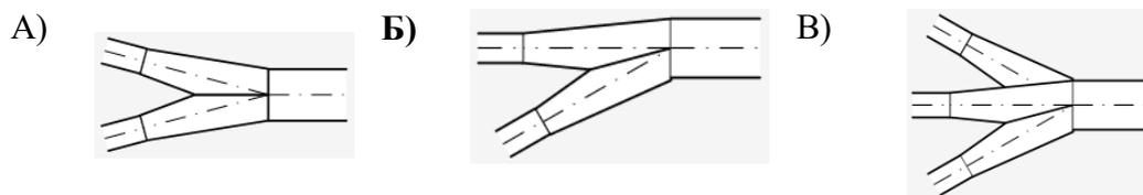
7. Условное обозначение на планах и разрезах воздухораспределителя с наклонными струями:
