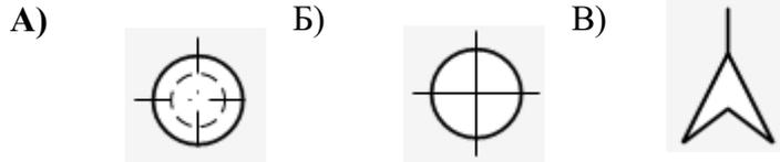
5. Условное обозначение на планах и разрезах воздуховода круглого сечения, идущего в видимую сторону:
