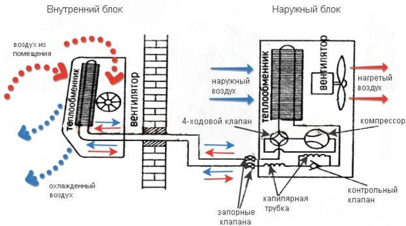
А) Схема работы инверторного кондиционера;
